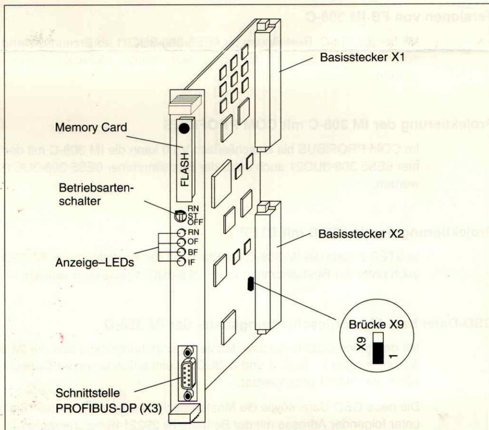
Bild 1-1 Masteranschlüsse IM 308-C
